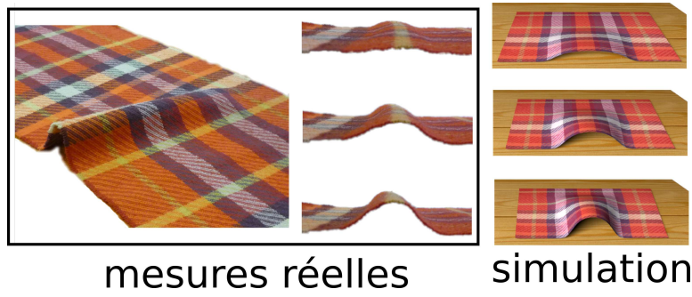
FIGURE 3.14 – Mesure réelle (gauche) de la courbure en fonction du taux de compression. Ces photos de plis peuvent être comparées aux résultats de notre simulation utilisant l’eq. (3.8).
