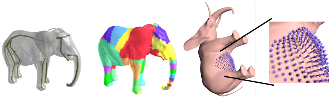
FIGURE 2.24 – Modèle d'éléphant utilisé pour la déformation à volume constant. De gauche à droite : Surface et son squelette d'animation ; Segmentation en région distincte en fonction des poids de skinning ; Mise en place de la pondération automatique au niveau du ventre permettant de localiser la déformation.
