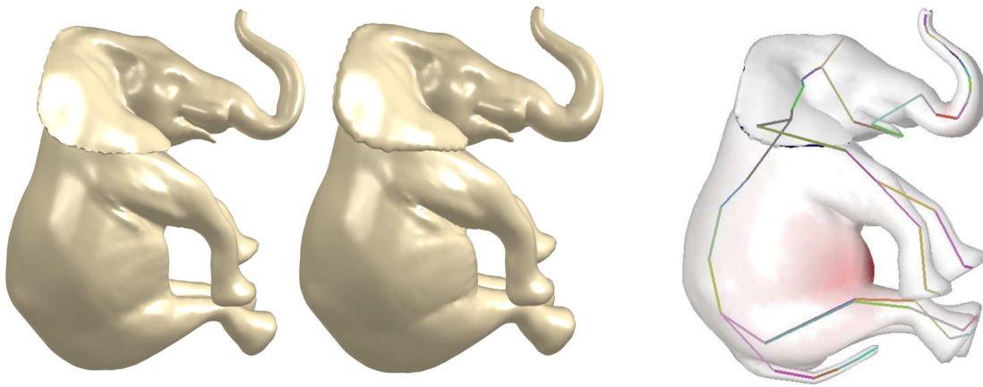
FIGURE 2.25 – Résultat de la préservation de volume. La figure de gauche correspond à une déformation par skinning classique. Sa perte de volume au niveau du ventre et de la trompe est de 5% du volume initial total. Après correction (milieu), le ventre et la trompe se gonflent localement. L'image de droite représente en couleur les poids de pondérations au niveau du ventre.
